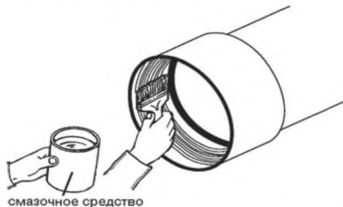
Рисунок Б.3 – Нанесение смазочного средства
